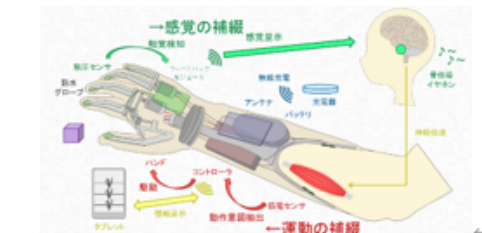
Fig.2. 開発目標となるサイボーグ義手の構造と機能
